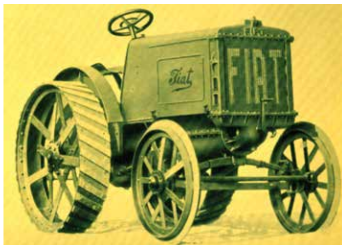
Prima trattrice Fiat con ruote metalliche e motore a petrolio (1919).
