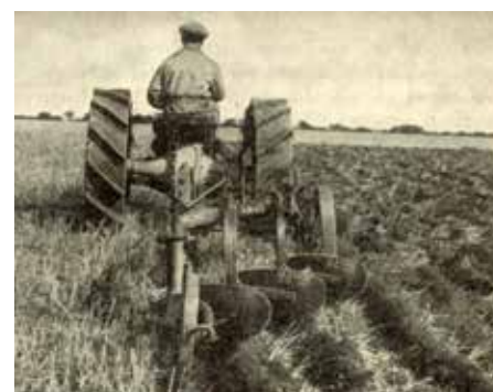
Campo di aridocoltura di Cerignola (Foggia): prove di aratura con monovomere Oliver 3° (sinistra) e con trivomere Oliver 283 (destra).
