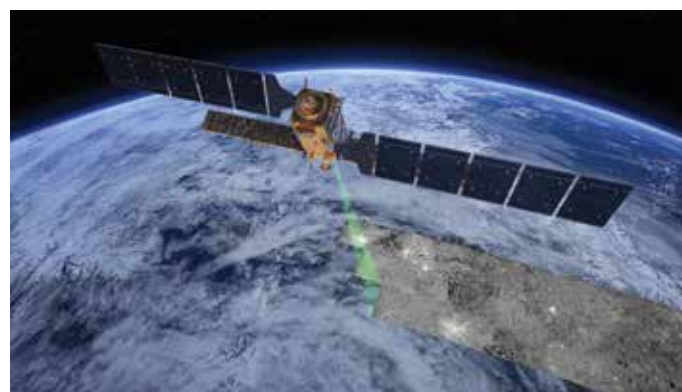
Nuovi satelliti artificiali della costellazione Sentinel dell'Agenzia Spaziale Europea (ESA): il satellite della missione Sentinel-1 sull'Italia (a sinistra); la missione Sentinel-1 assicura la disponibilità di immagini radar, giorno e notte e in tutte le condizioni climatiche (a destra) (foto dell'ESA).
