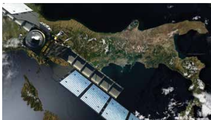
Nuovi satelliti artificiali della costellazione Sentinel dell'Agenzia Spaziale Europea (ESA): il satellite della missione Sentinel-1 sull'Italia (a sinistra); la missione Sentinel-1 assicura la disponibilità di immagini radar, giorno e notte e in tutte le condizioni climatiche (a destra) (foto dell'ESA).
