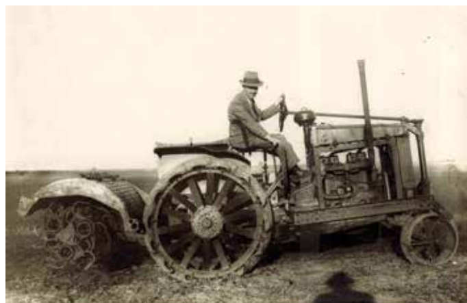
Campo di aridocoltura di Cerignola (Foggia): fresatrice Siemens-Schuckert in riposo, senza la protezione per far vedere l'organo di lavorazione del terreno.
