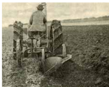
Campo di aridocoltura di Cerignola (Foggia): prove di aratura con monovomere Oliver 3° (sinistra) e con trivomere Oliver 283 (destra).
