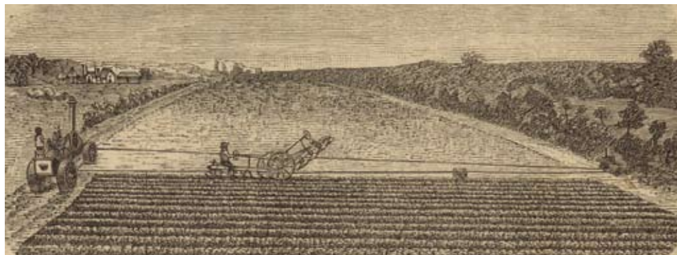
Figura 8. Sistema di aratura funicolare Fowler, con locomotiva e carro-ancora, che ebbe un ruolo importante nell'incremento della produzione di alimenti nel Regno Unito.
