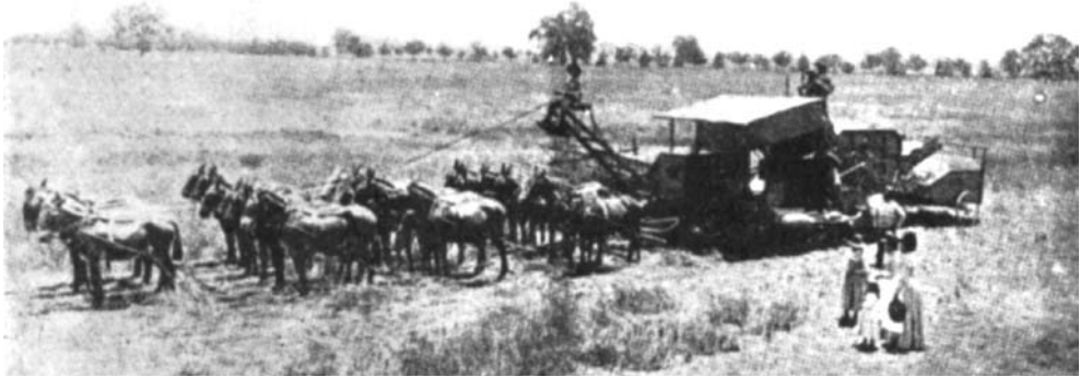
Figura 5. Mietitrice-trebbiatrice della ditta Shippee (1883) trainata da ventidue muli, in azione in California; costruita su scala industriale utilizzava i più efficienti brevetti dell'epoca.
