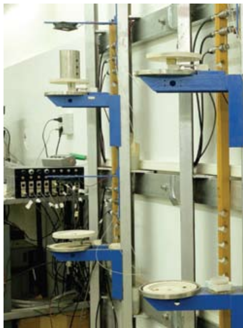
Figura 72. Caratterizzazione idraulica dei suoli: apparecchiatura di laboratorio per determinazioni su campioni non rimaneggiati con metodi di “stima dei parametri”.
