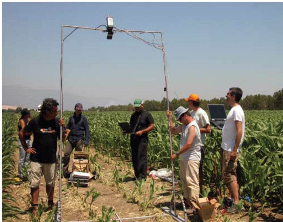
Figura 75. Misure radiometriche a terra per la calibrazione delle osservazioni da satellite.
