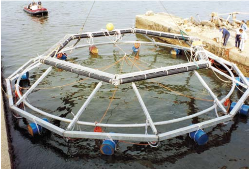
Figura 80. Studio sugli allevamenti ittici in mare aperto: varo di un prototipo di gabbia sommergibile progettata e realizzata a Portici dall'Istituto di Meccanica agraria.
