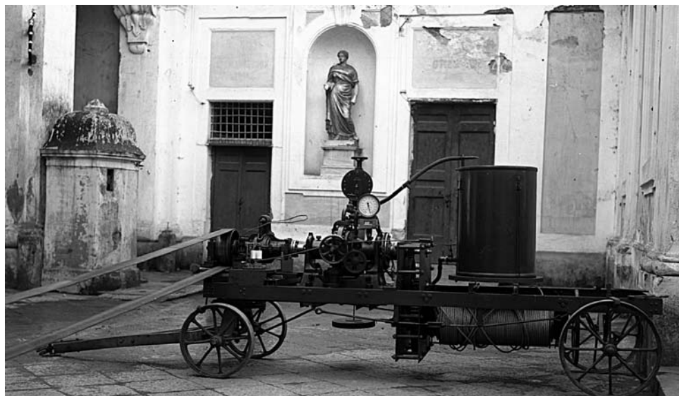
Figura 43. Prove per la determinazione del rendimento e dell' indice di aderenza delle trattrici: argano freno impiegato nelle prove.
