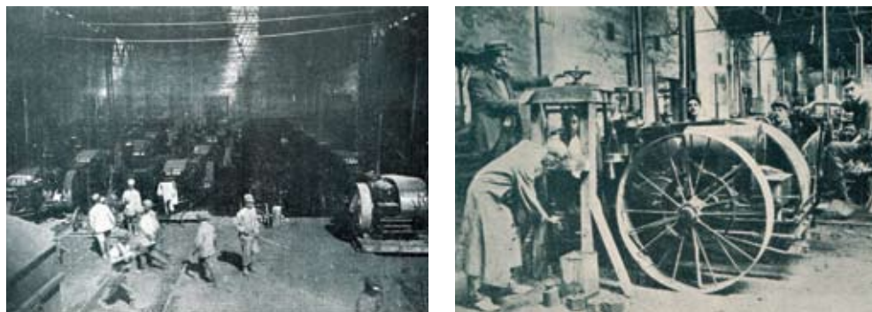
Figura 32. Servizio di Motoaratura di Stato: montaggio (a sinistra) e collaudo (a destra) a Napoli delle trattrici americane “Case”, con l’impiego di militari.
