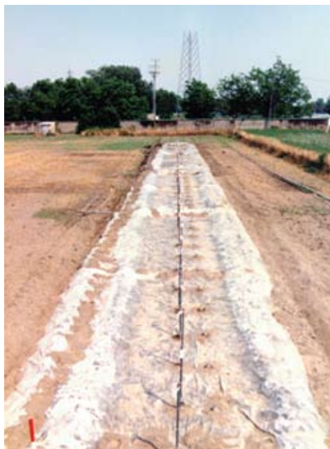
Figura 73. Caratterizzazione dei suoli: prova di campo per la valutazione della variabilità spaziale delle caratteristiche idrauliche.
