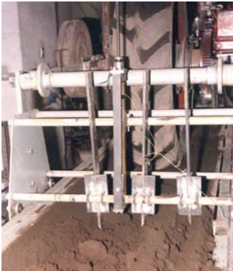
Figura 79. Attrezzatura di laboratorio per lo studio delle interazioni tra le ruote motrici delle trattrici e il terreno, in condizioni diverse di carico e di slittamento.
