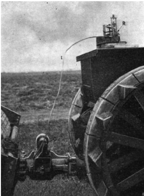
Figura 40. Campo sperimentale di Cerignola, prova della fresatrice Siemens, 26 kW: vista d'insieme (in alto); particolare del dinamometro a rotazione con registratore (a sinistra).
