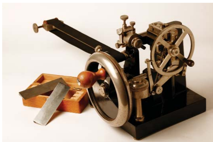
Microtomo rotativo a lama fissa tipo "Minot" e relativi coltelli (prima metà XX secolo).
