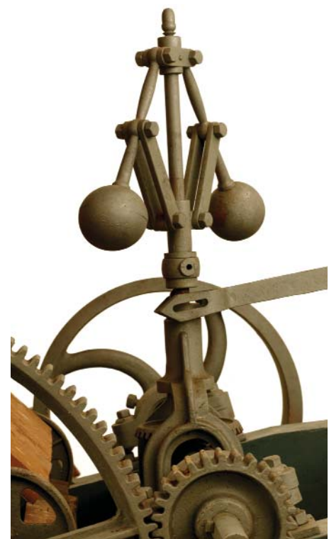
Locomobile del 1887: particolare del regolatore di velocità.
