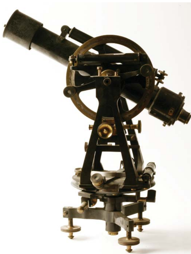
Tacheometro ripetitore con micrometri opposti ai cerchi; lettura a stima; livella d'indice zenitale, livella sull'alidada e livella sul cannocchiale - Troughon & Simms, Londra 1888 (Strumento per la misura di angoli orizzontali, verticali, di distanze topografiche e di dislivelli).
