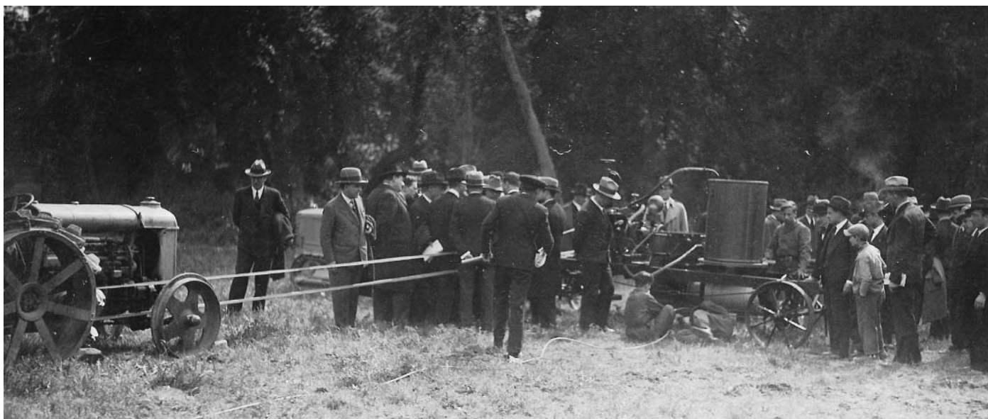
Prove di trazione con carro dinamometrico, presso la Facoltà di Agraria di Portici.
