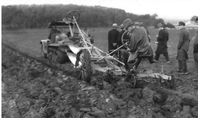
Prove di trazione con argano freno, eseguite presso i campi sperimentali dell'Istituto di Meccanica Agraria.
