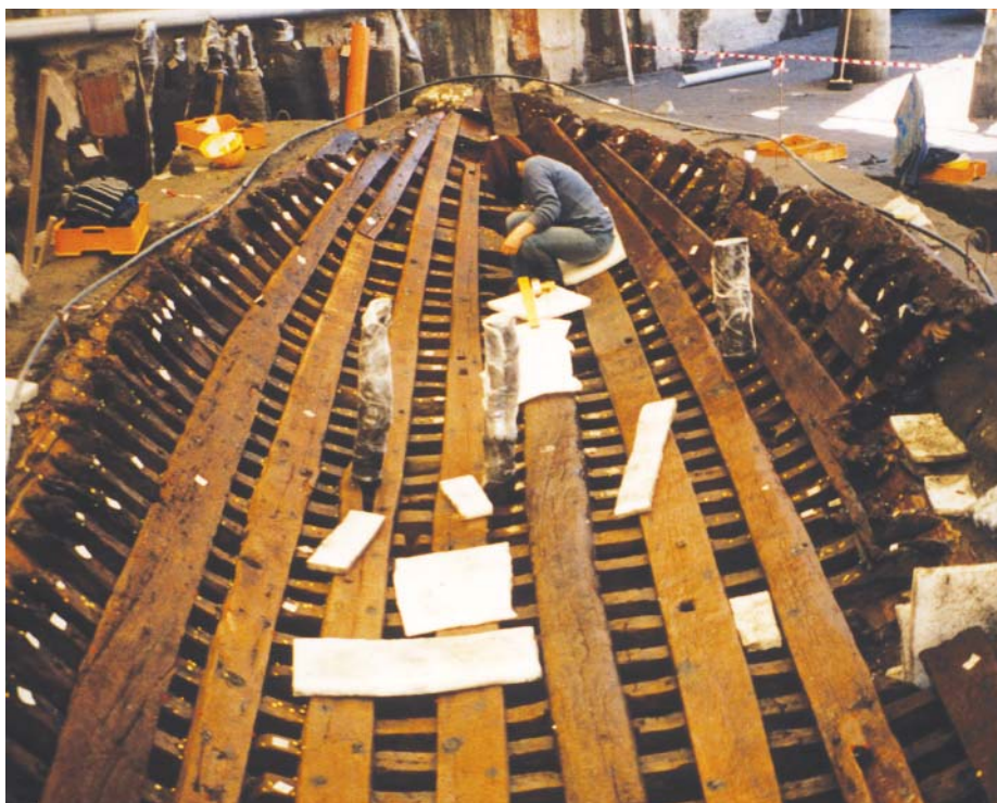
Campionamento degli elementi strutturali da una nave romana rinvenuta nell'antico porto di Neapolis.
