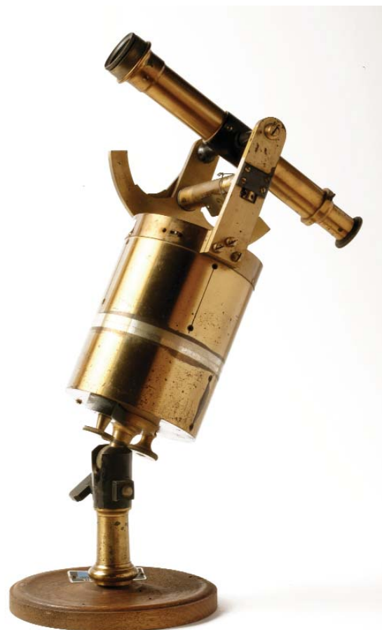
Squadro-goniometro cilindrico con cannocchiale munito di settore verticale graduato di ampiezza 80^\circ . Letture alla graduazione azimutale ed al settore verticale, a mezzo nonio. Bussola magnetica - Gaetano Spano, Napoli 1888 (Strumento per tracciare allineamenti ad angoli retti o semiretti o per la misura di angoli orizzontali, verticali e di distanze topografiche).
